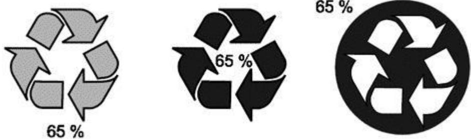
Рисунок Е.2 - Примеры изображения знака "лента Мебиуса" в информации о содержании вторичного сырья, использованного при изготовлении упаковочного материала
